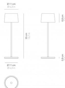
Olivia pro è una lampada a batteria portatile e ricaricabile da tavolo. È dotata di: base di ricarica a contatto, touch dimmer e della funzione di memoria dell'impostazione di dimmerazione che memorizza gli step di dimmerazione. Di conseguenza, ad ogni accensione, l'intensità luminosa corrisponderà a quella precedentemente impostata. La lampada è dotata inoltre della funzione di selezione della temperatura di colore della luce tra 2700 e 3000° Kelvin (bianco dinamico).
