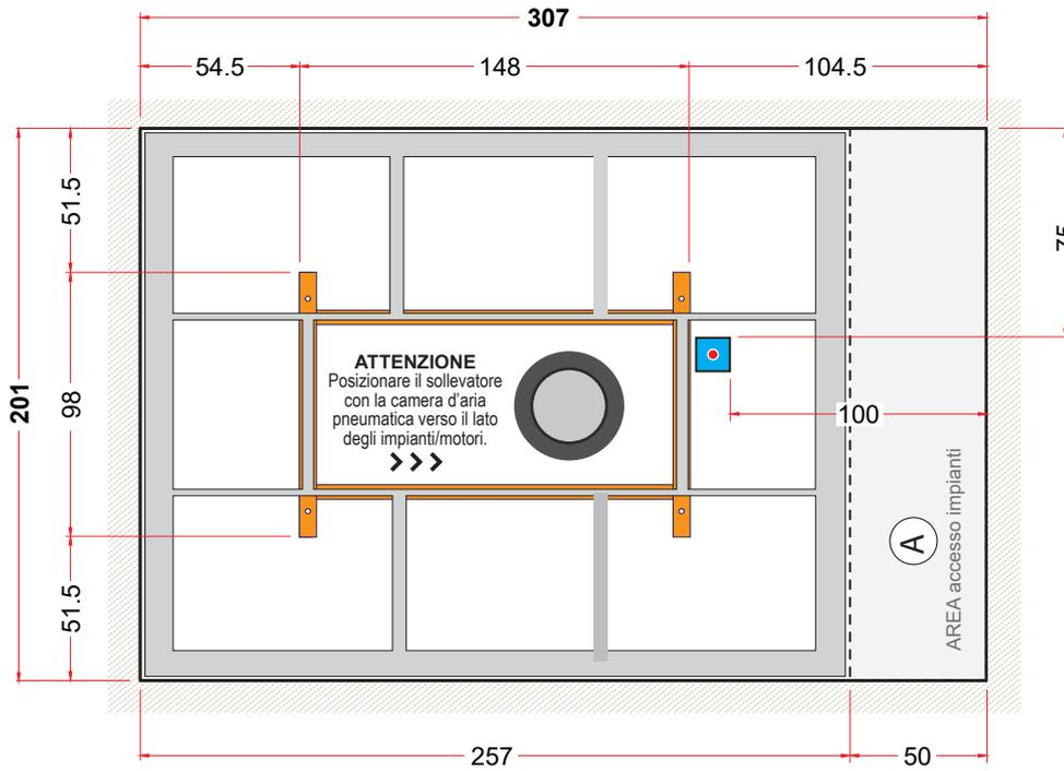
PROVVEDERE AL FISSAGGIO A TERRA DEL SOLLEVATORE SOLO DOPO AVER FATTO LA PROVA DI ESCURSIONE CON IL SOLO CONTROTELAIO.
